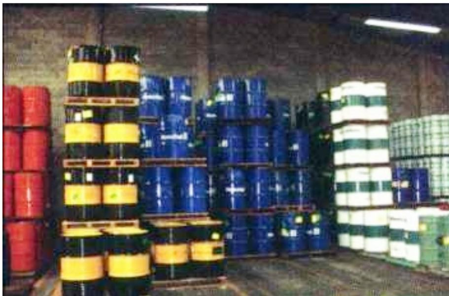
Los productos muy inflamables (con un punto de inflamación inferior a 55° C) o aerosoles, deben almacenarse separados. Esta separación se obtiene construyendo un sector con paredes resistentes al fuego (aplicable sólo en grandes almacenes).
